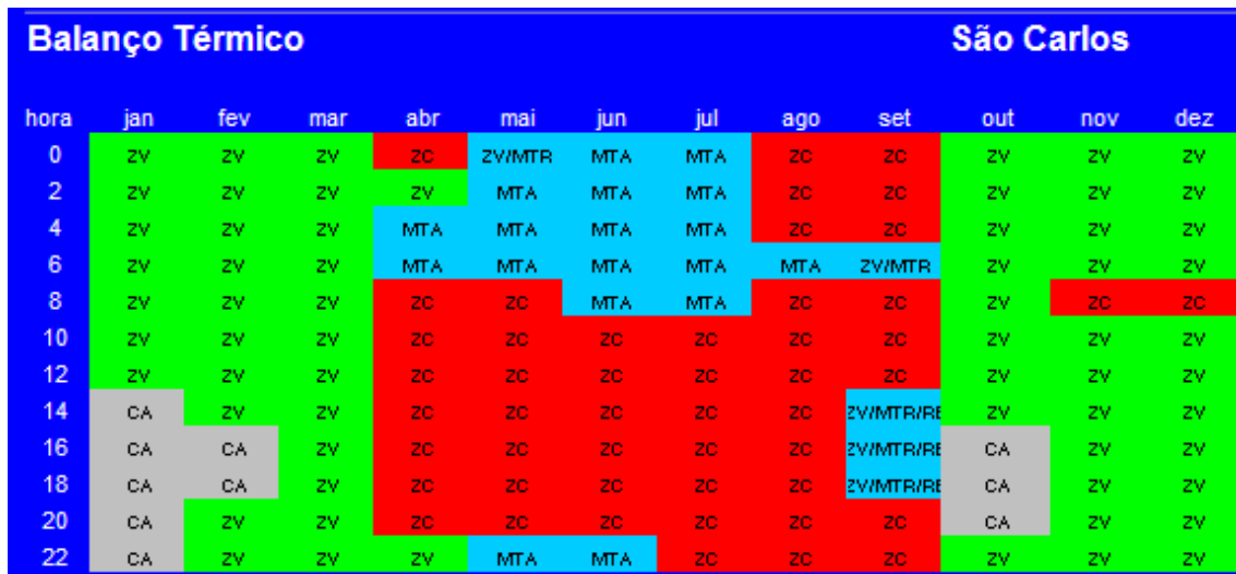
Figura 11: Balanço térmico horário em São Carlos, obtido através da Carta Bioclimática. ZV= ventilação, CA= condicionamento artificial, ZC= conforto, MTA= massa térmica aquecimento MTR= massa térmica resfriamento.
