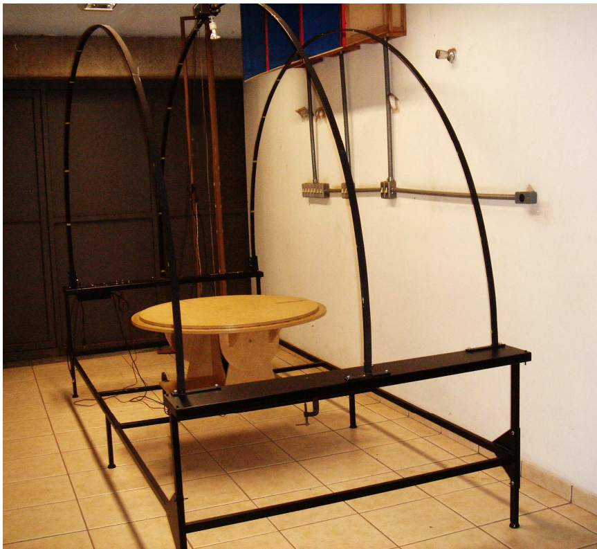
Figura 1: Heliodon (Laboratório de Conforto – EESC/USP)
