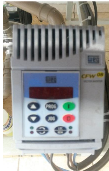
Mecanismo de controle da mesa, ligando, desligando e controlando a velocidade.
