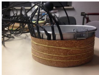
Figura A.3 - Isolamento do sistema com cortiça
