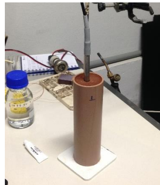
(b) medição da condutividade da amostra
