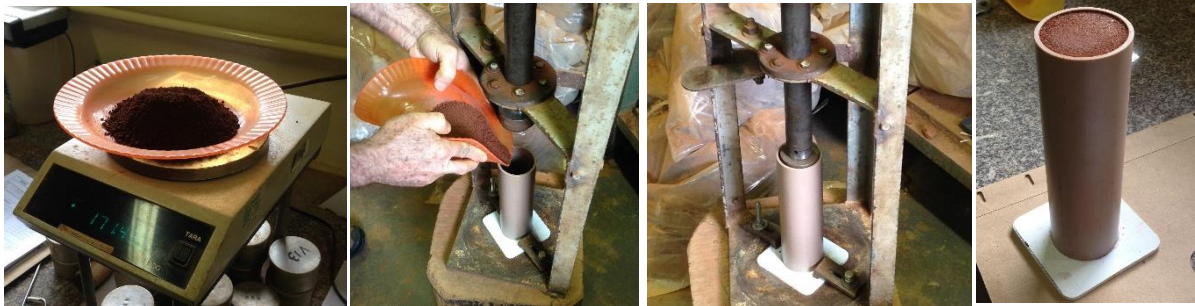
Figura E.3 – Etapas do ensaio de compactação
