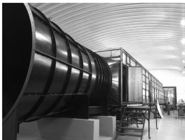
Figura 53 - Túnel de vento do IPT. Fonte o autor
