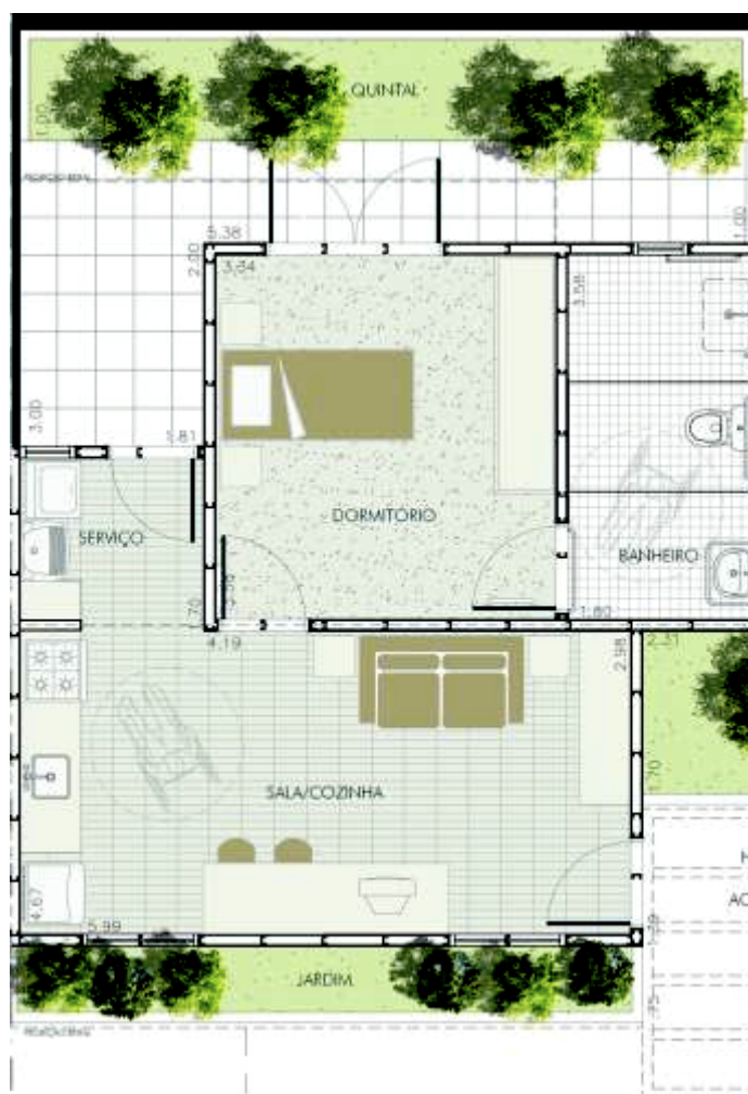
Figura 4: Planta da habitação para idosos projeto de Aflalo e Gasperini com indicação de cadeiras de rodas e correspondente área de giro
