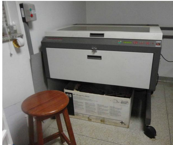
Figura 30 – Cortadora a laser do Lapac – Unicamp – ULS X-660 - 60 Fonte: foto da pesquisadora, tirada em 27/04/2012
