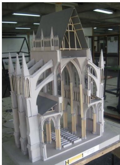
Figura 6: Maquete finalizada do corte da Catedral de Reims
