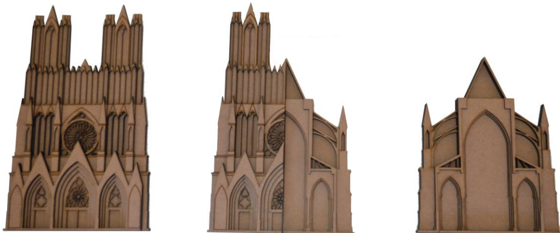
Figura 1: desenhos com profundidade feitos em camadas e cortados a laser. Material: madeira.
