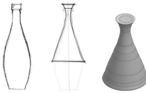
Figura 2: Croqui; estudo de reproposição; novo modelo digital Solidworks . Fonte: VEIGA, J. n.elac, IAU.USP. 2014.
