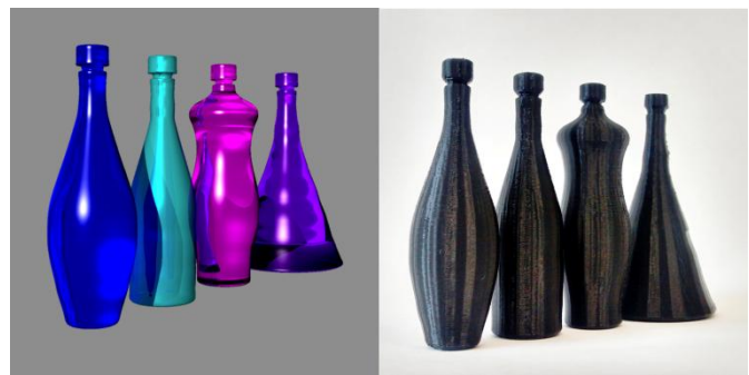
Figura 4: Comparativo entre modelos digitais renderizados em Rhino e modelos impressos tridimensionalmente. Fonte: VEIGA, J. n.elac, IAU.USP. 2014.
