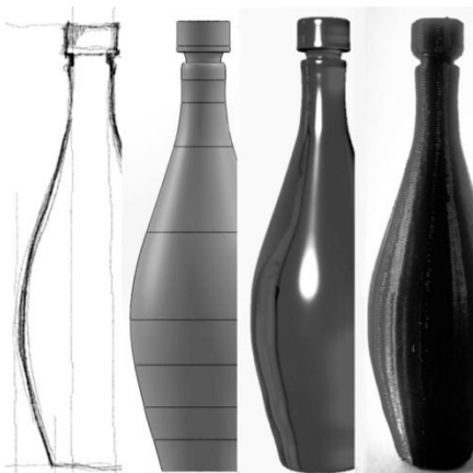
Figura 1: Croqui; modelo digital SolidWorks ; modelo digital parametrizado Grasshopper ; modelo físico impresso. Fonte: VEIGA, J. n.elac, IAU.USP. 2014.
