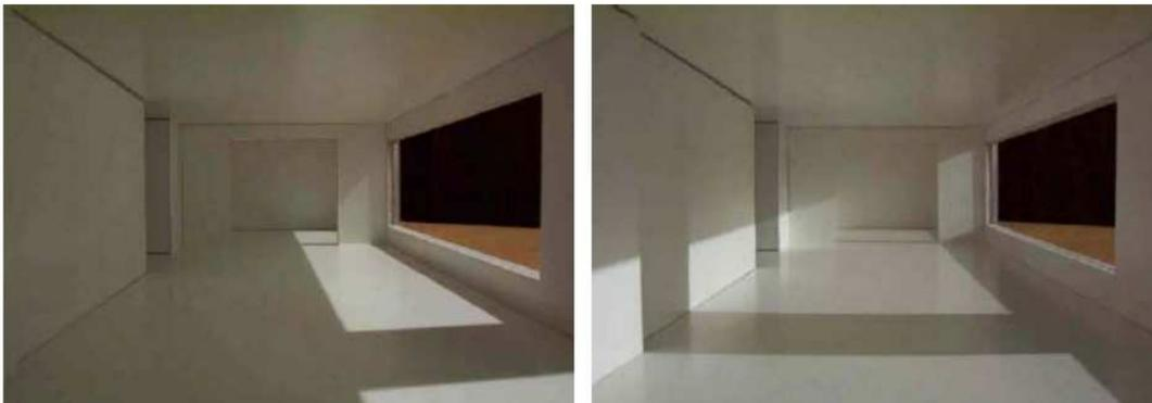
Figuras 45 e 46: Ensaio no heliodon no interior da sala de estar. A figura 44 se refere ao equinócio às 14h e a figura 45 se refere ao inverno, às 15h.
