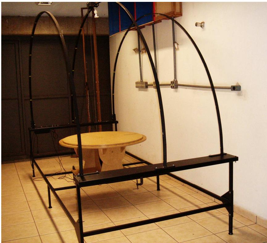
Figura 1: Heliodon (Laboratório de Conforto – EESC/USP)
