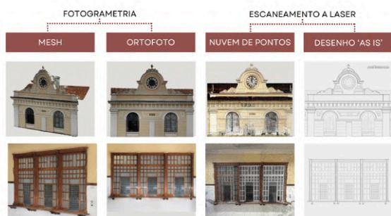
Figura 2: Esquema dos resultados finais a partir da fotogrametria e escaneamento a laser (Fonte: Autora, 2024)
