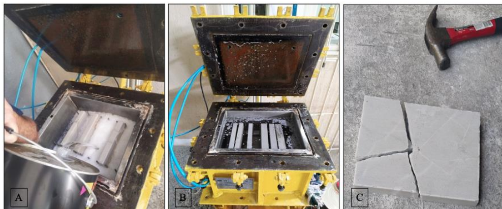
Figura 3. (A) Adição do impermeabilizante na câmara, (B) amostras submersas antes da aplicação de pressão (C) quebra da amostra após a cura para verificar a penetrabilidade do impermeabilizante
